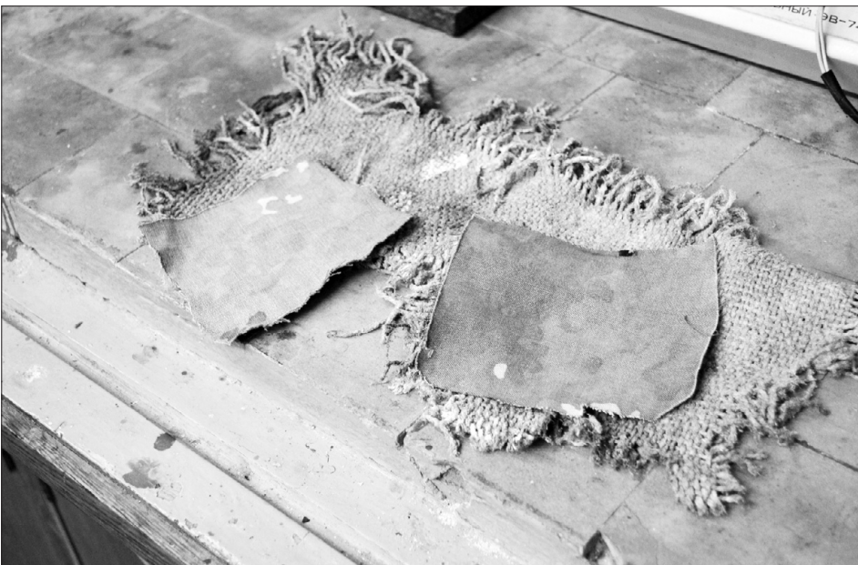
Справа – необроблений (звичайний) зразок тканини, зліва – оброблений розчином антипірену.
